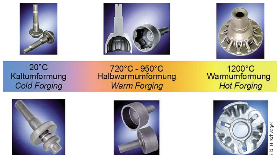
Bild 3: Abgrenzung von Kalt-, Halbwarm- und Warmumformung.
